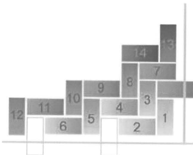
Corte dos blocos para acabamento e ajustes necessários
