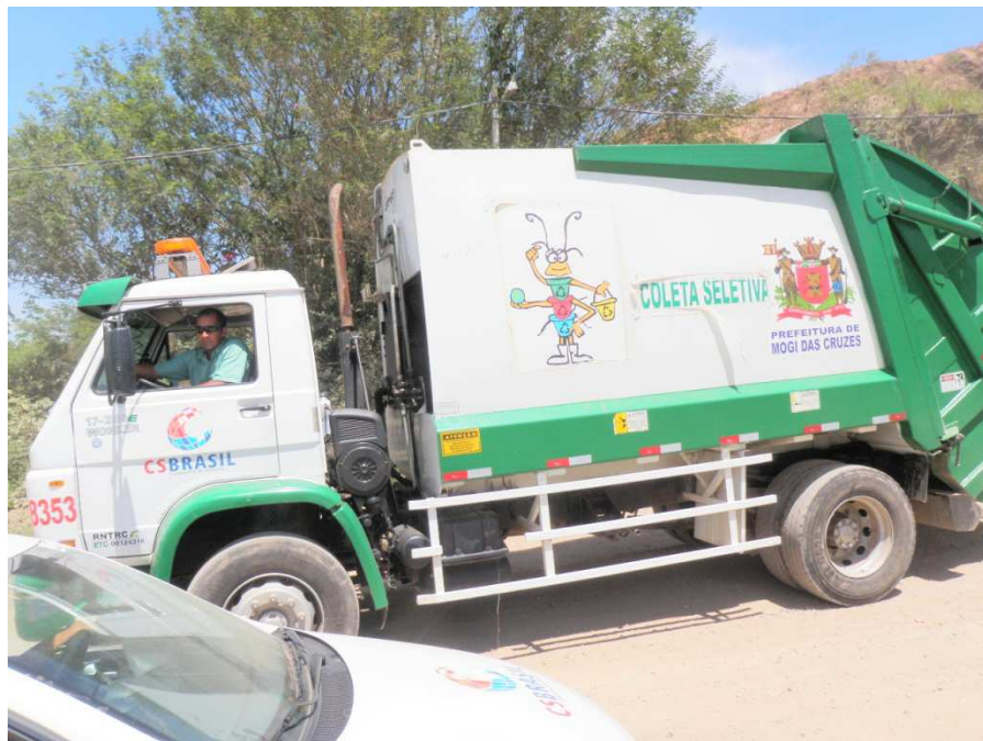
Foto 4 Compactador utilizado na coleta seletiva
