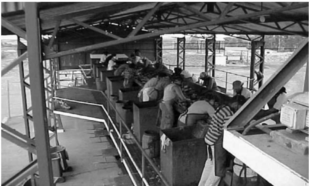
Figura 15 Esteira de separação de usina de compostagem simplificada (Castilhos Jr (coordenador), 2006)
